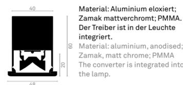
Material: Aluminium eloxiert; Zamak mattverchromt; PMMA. Der Treiber ist in der Leuchte integriert.
