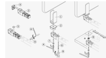
Der mit dem Oberrahmen fest verbundene Systemadapter wird zusammen mit dem AFT und der Wandklemme verschraubt. Die Konstruktion erlaubt auch – mit Hilfe einer zusätzlichen Unterlegscheibe – die Nutzung einer eventuell vorhandenen Schiebeplattenfunktion. Das Tischadapterset ist sowohl für 19 mm als auch für 25 mm starke Tischplatten erhältlich.
