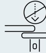
**| D | DER AUFFAHRSSCHUTZ** erkennt, wenn die Tischplatte auf ein stabiles Hindernis trifft. Die Tischplatte stoppt und fährt in eine sichere Position zurück. Optional kann ein hochemsensibler externer Gyro-Sensor eingesetzt werden.
